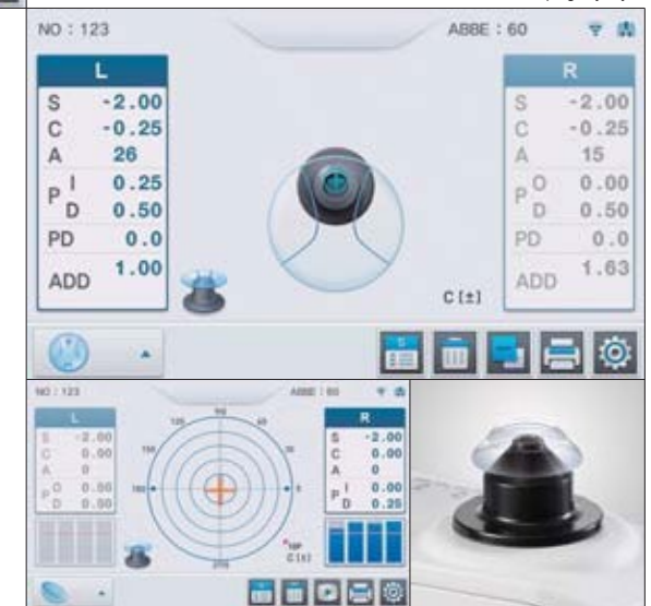
Pomiar soczewki kontaktowej
